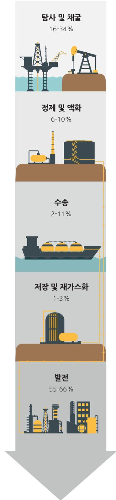
그림 3. 액화천연가스(LNG) 생산주기 온실가스 배출 구성
